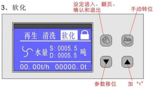
图 4:流量模式工位显示界面
